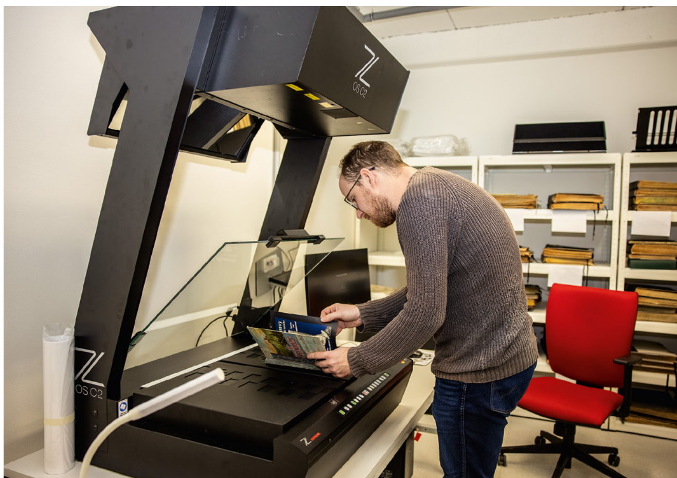
Jeden ze čtyř nových skenerů na KDJ – planetární knižní skener formátu A2 Zeuschel OS C2 Advanced – při provozu.
